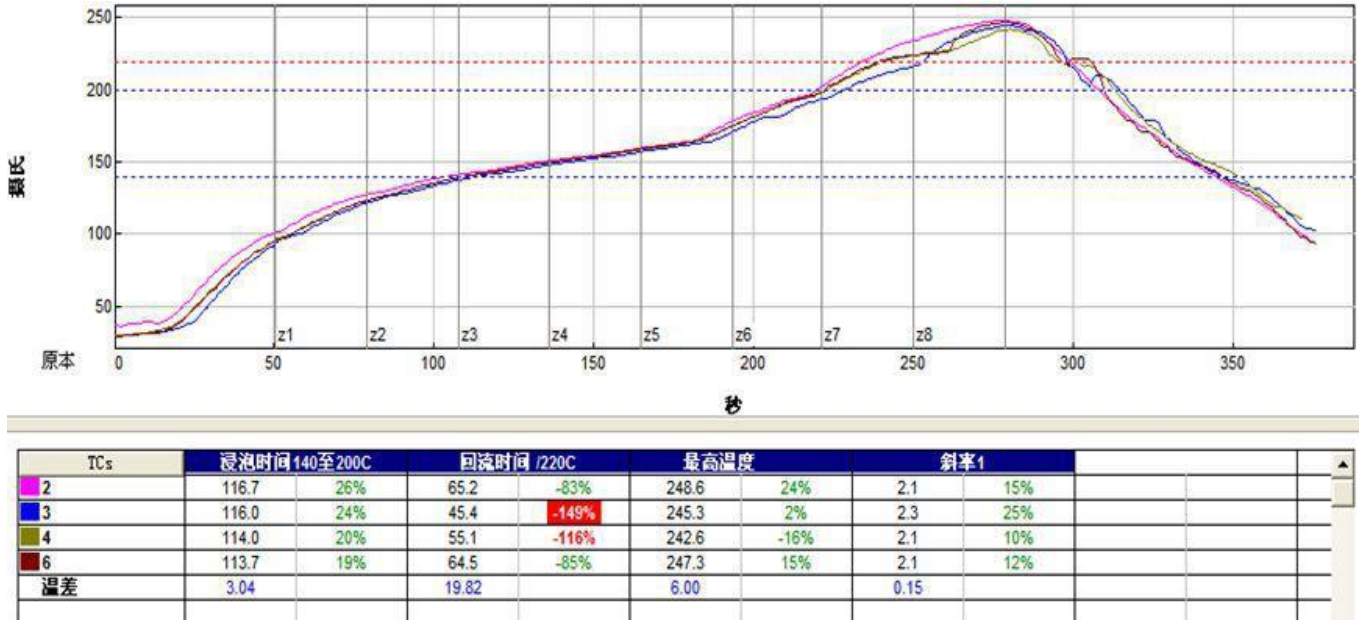
图片14 回流焊接温度曲线图
